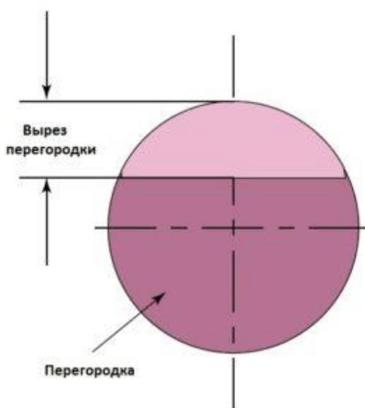
Рисунок 9 – Перегородка, используемая в теплообменном аппарате [12]
